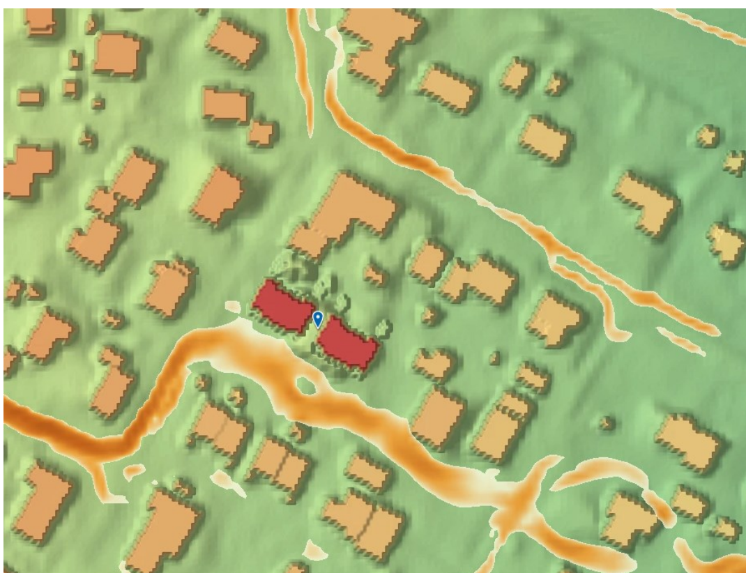
Figur 10. Rinnvåg vid skyfall, underlag från Tyresö kommun inlagt i Scalgo.
